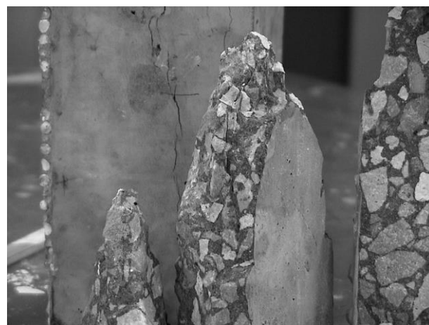
Рисунок 5. Характер разрушения образца . ( призмы 70/70/280мм .)
