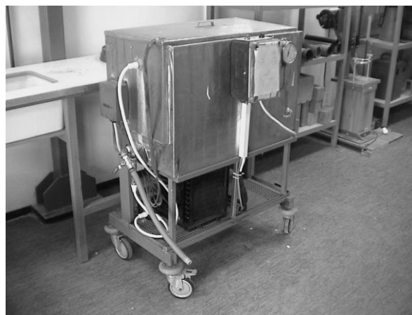
Рисунок 1. Установка для выдержки образцов в воде при температуре 20-21 градус цельсия.
