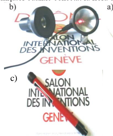
Figura 3. Emițătoare cuantice cu capuri optice de tip clopoțel (a), cu magnet permanent (b), de tip creion (c).
