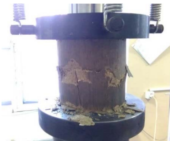
Figura 2. Determinarea rezistenței la compresiune axială.
