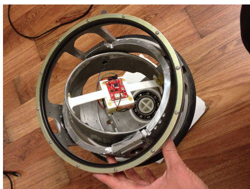
Fig.3. Giroscop de laborator cu 3 axe de libertate.
