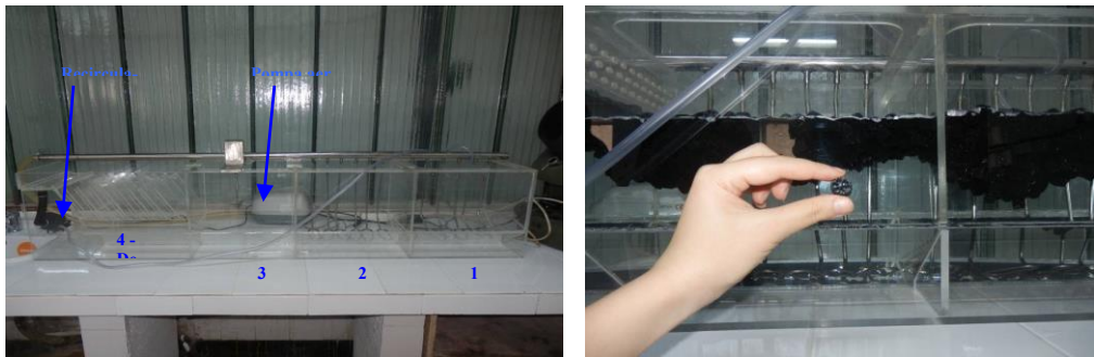
Figura 2: Model experimental instalatie de epurare tip MBBR (1,2 - Bazin aerob cu 6 difuzori metalici perforati, 3 - Bazin anoxic cu mixer, 4 - Decantor lamelar cu 8 lamele)
