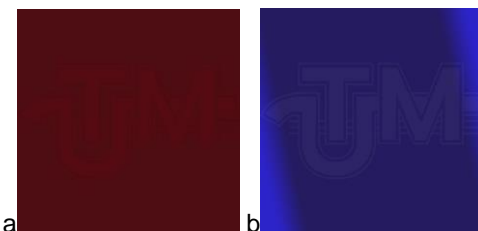
Figura 3: Imagine imprimată cu cerneluri cu pigmenți fluorescenți a – imagine invizibilă; b – imagine vizibilă sub acțiunea razelor UV
