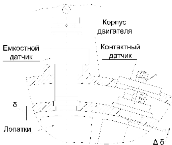
Рис. 2. Измерения с емкостным датчиком и смещённым контактным датчиком
