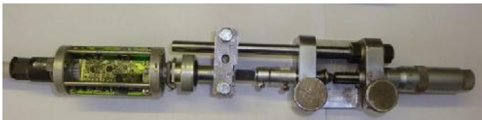
Рис.4. Фото статического стенда формирования данных для калибровочных таблиц.
