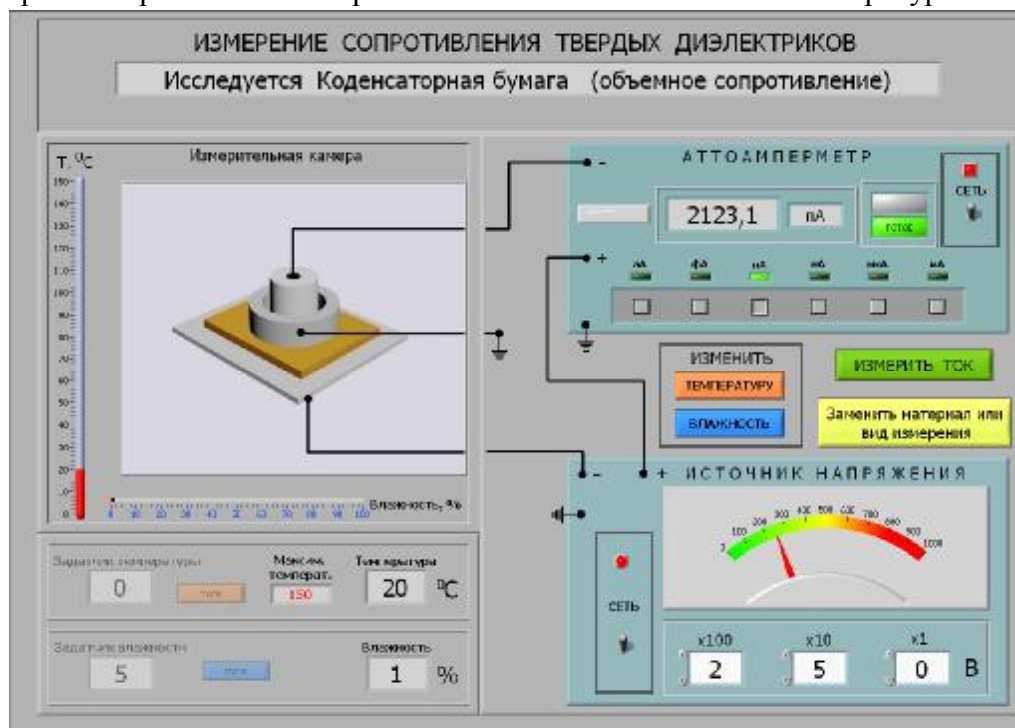
Рис. 2. Окно виртуального лабораторного стенда по исследованию сопротивления твердых диэлектриков
