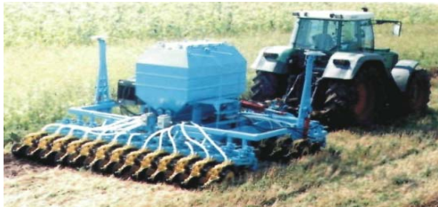
Fig. 3.23. Mașină combinată de lucrat solul și semănat în teren nearat.
