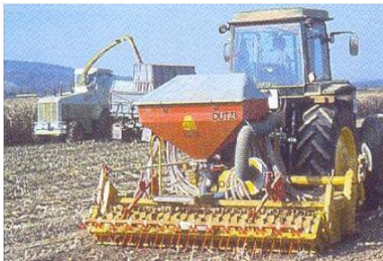
Fig. 3.25. Agregat combinat pentru înființarea culturilor agricole în teren nearat, printr-o singură trecere a agregatului pe sol (DUTZI- Germania).
