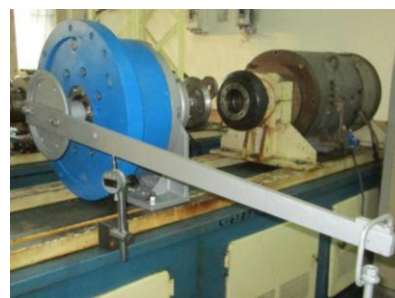
Fig. 25. Cercetarea rigidității torsionale.
