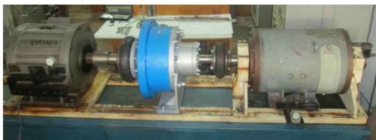
Fig. 24. Standul experimental pentru încercarea transmisiei precesionale în regim de multiplicator.
