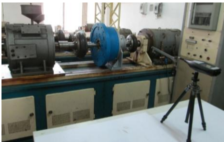
Fig. 29. Măsurarea zgomotului multiplicatorului precesional.
