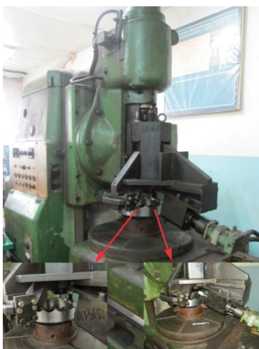
Fig. 20. Mașină unealtă cu dispozitiv special de generare a dinților roților centrale.
