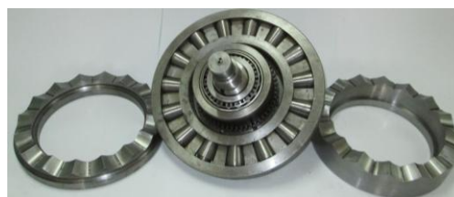
Fig. 21. Roțile dințate centrale și nodul satelit.
