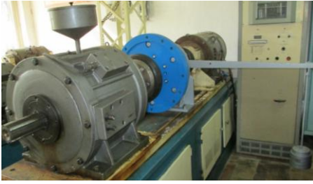
Fig. 27 Stand pentru determinarea momentului de pornire.
