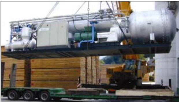
Figura 2. Instalație ORC, 400 kW, Austria [5]
