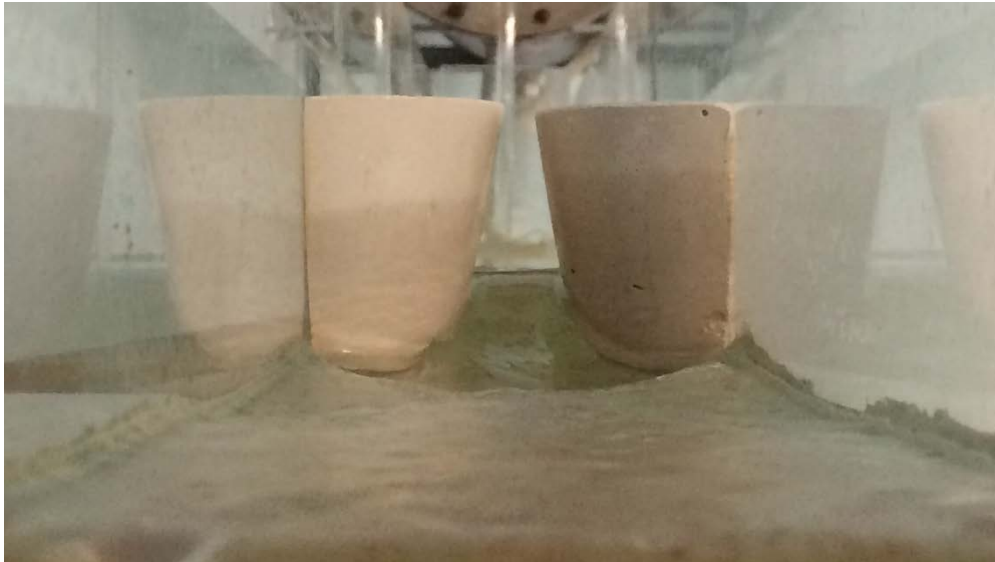
Fig 3. Imaginarea frontală a canalului-deversor cu pereți parabolici.
