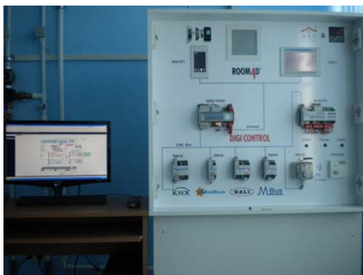
Fig. 2. Vederea panoului de automatizări a complexului de instalații din dotarea încăperii experimentate.
