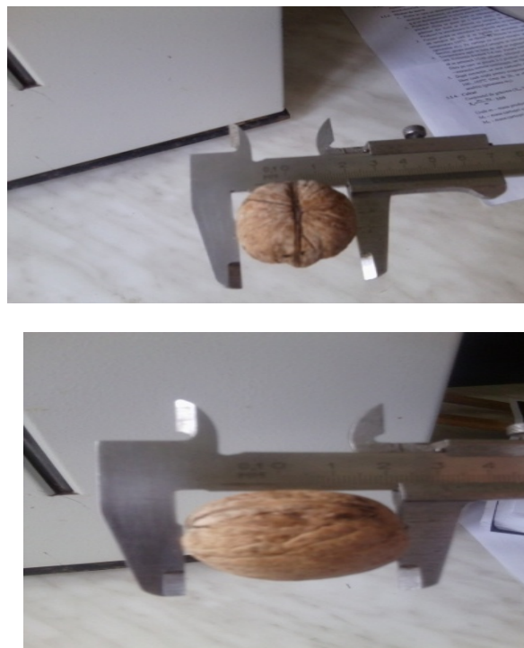
Figura 1. Măsurarea dimensiunilor nucilor cu șublerul.
