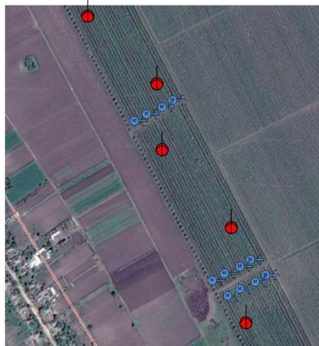
Figura 5.5. Harta de plasare a modulelor de senzori integrați și a modulelor de control al supapelor pentru sistemul de irigare la Întreprinderea agricolă ”Fortuna Lapis”(Ungheni)
