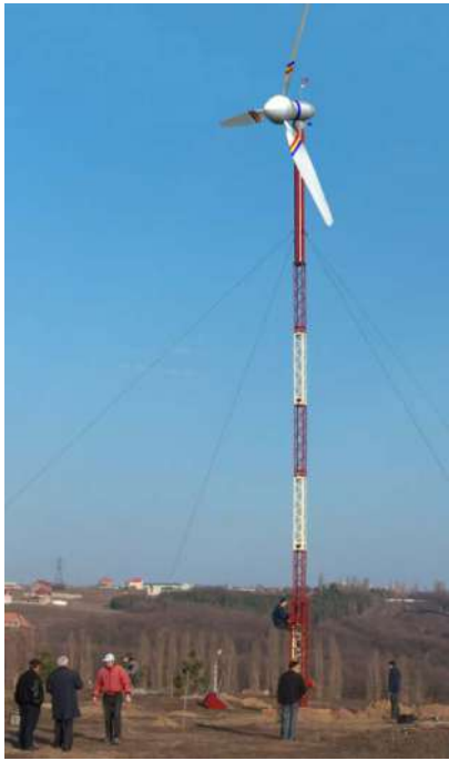
Figura 7.1 (b) Turbine eoliene fabricate la UTM cu orientare cu servomotor la direcția vântului, puterea nominală de 10kW
