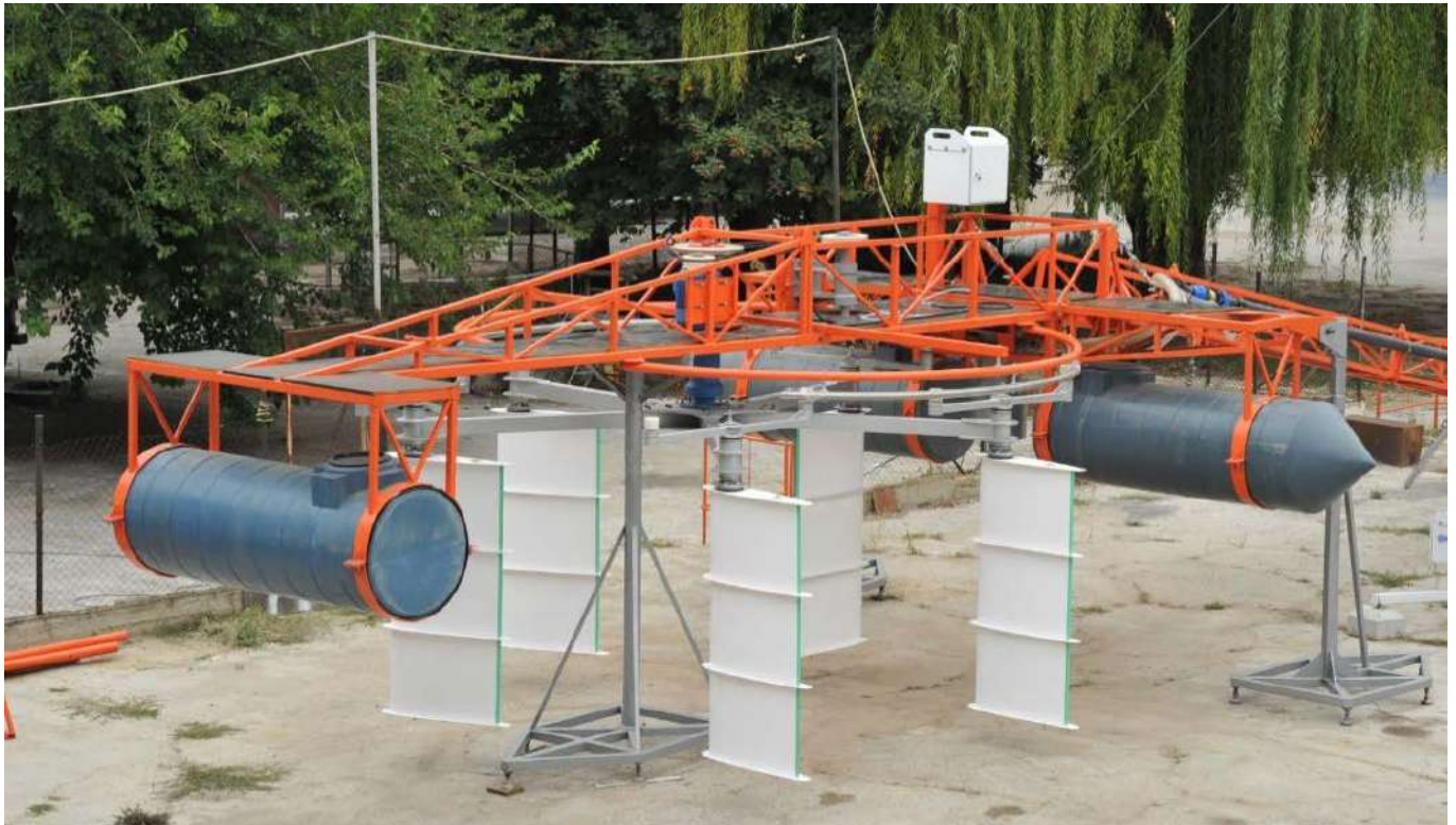
Microhidrocentrala de flux cu rotor hidrodinamic basculant cu 5 pale cu lungimea cordului l=800\text{mm} și ecrane pentru direcționarea curgerii fluidului
