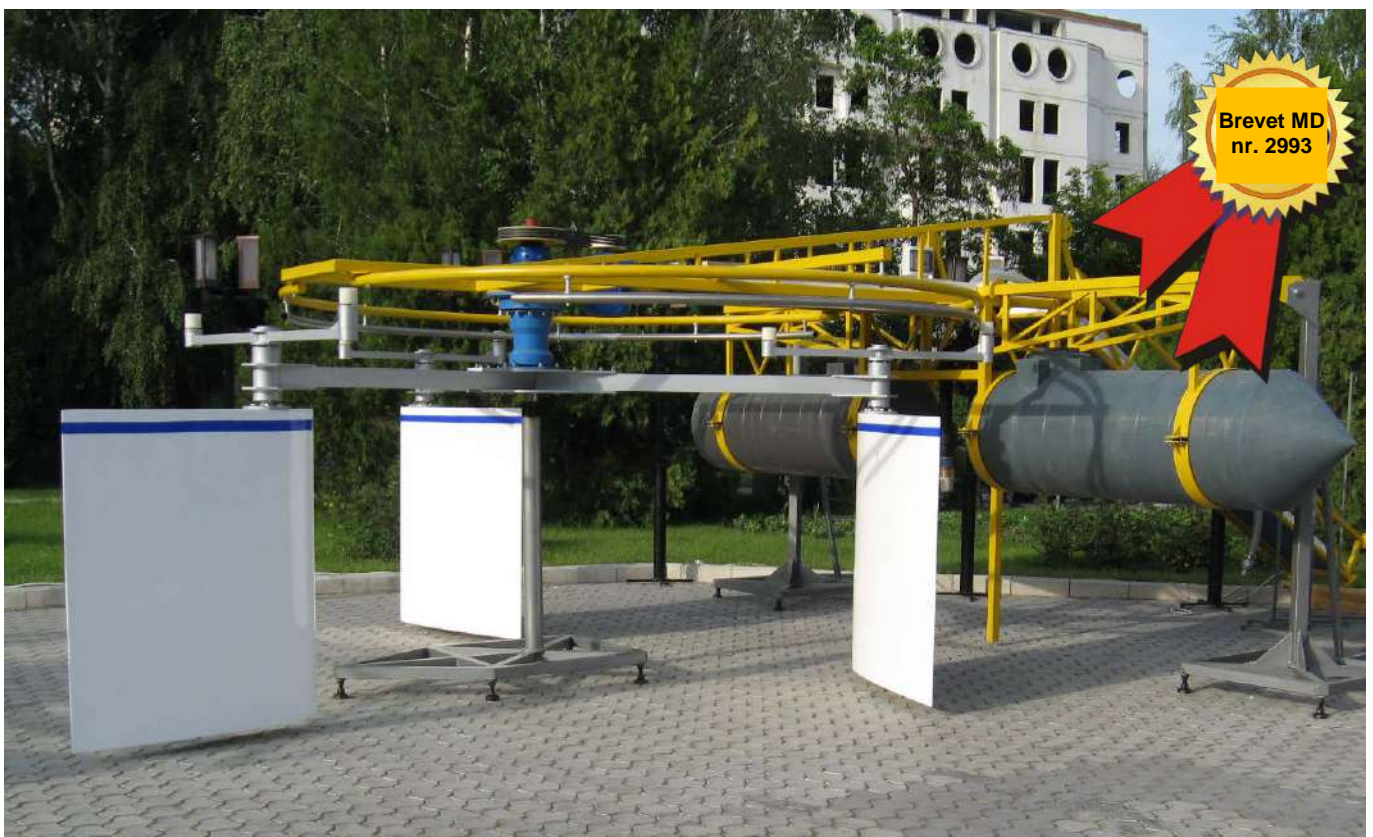
Figura 7.2 (b) Microhidrocentrale de flux cu rotor hidrodinamic cu 5 și 3 pale cu lungimea cordului l=1300\text{mm}
