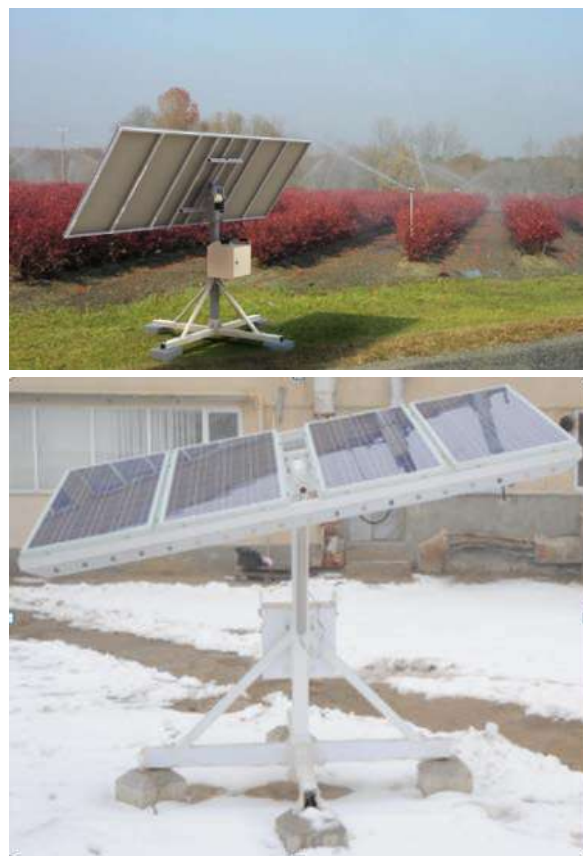
Figura 7.3 (c) Instalații fotovoltaice elaborate cu puterea 750W utilizat în sistemele de protecție antigrindină
