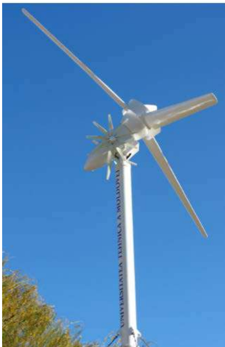
Figura 7.1 (d) Turbina eoliană cu orientare aerodinamică la direcția vântului cu roți windrose, puterea nominală de 10 kW.
