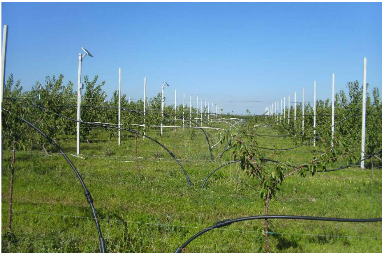
Figura 5.6. Vedere reală a amplasării modulelor de senzori integrați și de comandă a supapei pentru sistemul de irigare
