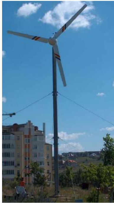
Figura 7.1 (b) Turbine eoliene fabricate la UTM cu orientare cu servomotor la direcția vântului, puterea nominală de 10kW
