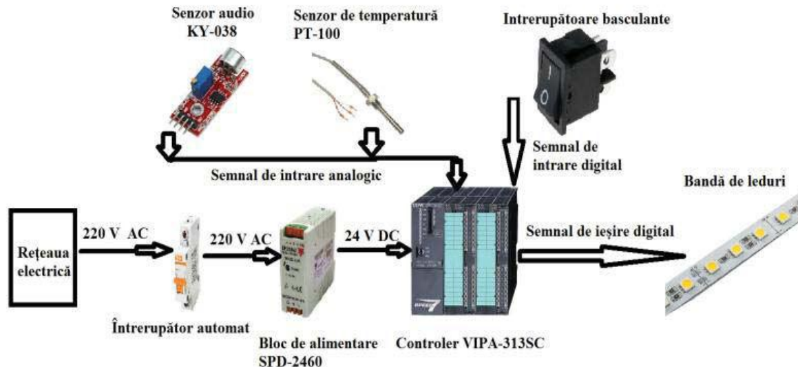
Fig. 8. Structura și schema electrică a standului elaborat pentru controlul temperaturii și a amplitudinii undelor sonore prin intermediul controlerului VIPA-300 S
