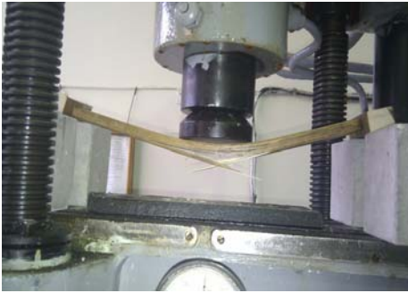
Fig. 8 Supunerea la încercare a elementelor de legătură.
