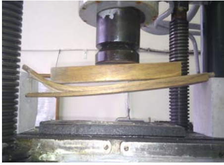
Fig. 7 Supunerea la încercare a elementelor șezutei.
