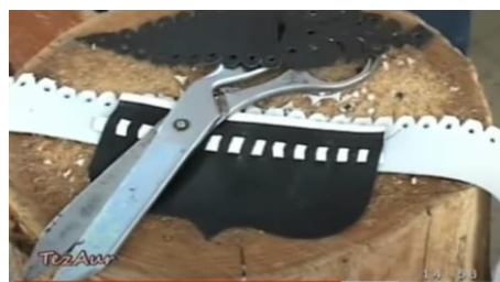
Figura 4. Dantelarea fâșiei și perforarea buzunarului inferior [3]
