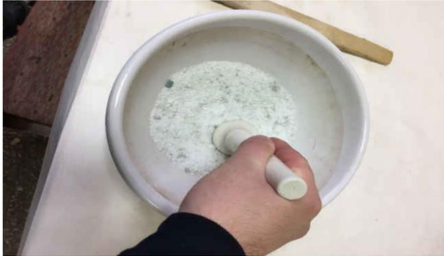
**Рисунок 2.1.** Измельчение технической соли в ступке
