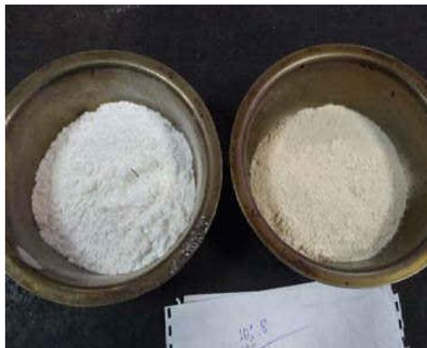
**Рисунок 3.1.** Слева - Наполнитель (реагент) для борьбы с зимней скользкостью на основе технической соли, справа - минеральный порошок
