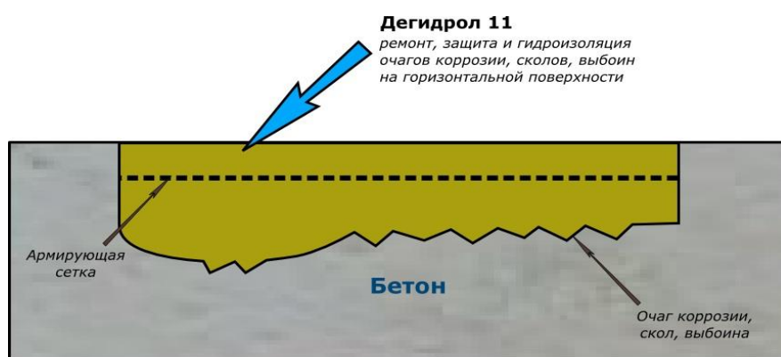
Рис.7. Места, где обнаружена коррозия, зачищают и покрывают специальными грунтовками. Они обеспечивают гидро- и пароизоляцию, а следовательно, замедляют разрушение.
