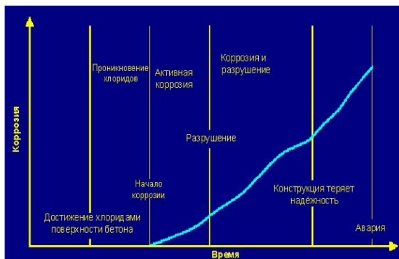
Рис.3. На графике представлена зависимость скорости разрушения от времени воздействия неблагоприятных факторов.
