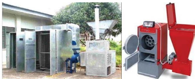
Fig. 4. Instalație de uscare ce are ca sursă de energie biomasa [7]
