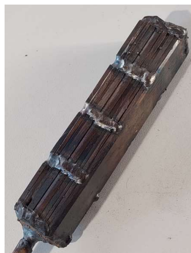
Figura 3. Aspectul pachetului de fâșii de tablă după crearea unor cordoane de sudură și respectiv sudarea unei tije pentru manevrarea probei la presare
