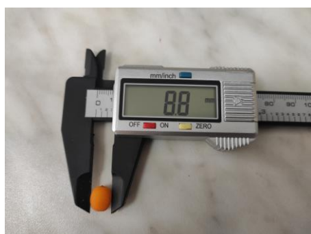
Рис. 2. Измерение геометрических размеров ягод
