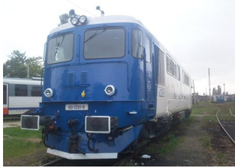
Fig.6 Locomotiva diesel-electrica 060 DA dotata cu convertor static tip INDA si echipament EPSAI
