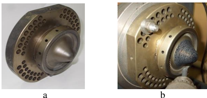
Fig. 4.7. Vederea generală a paletelor de finisare: a) în condiții normale; b) după acoperirea cu peliculă de grafit [29]
