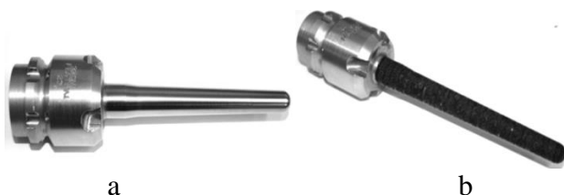
Fig. 4.6. Vedere generală a suprafeței poansonului: a) inițial; b) după prelucrare [29]
