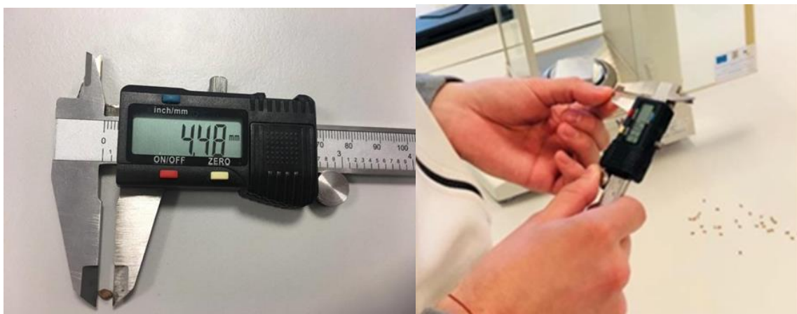
Figura 1. Determinarea diametrului și lungimii semințelor cu șublerul electronic
