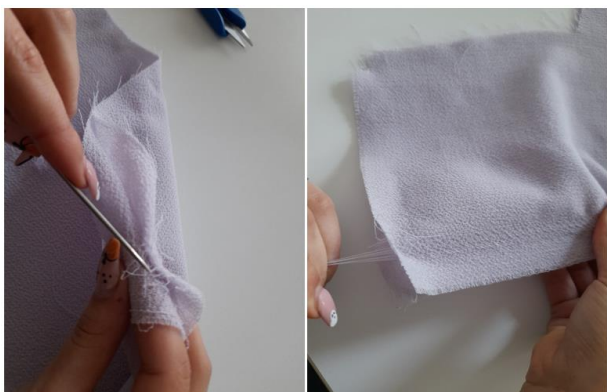
a) Desfacerea manuală a marginilor reperelor
