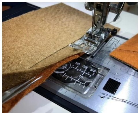
b) Aplicarea tighelului limitator la distanța 10 mm de la marginea și desfacerea manuală a reperelor.
