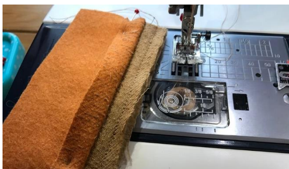
c) Asamblarea a două reperi doar pe un strat
