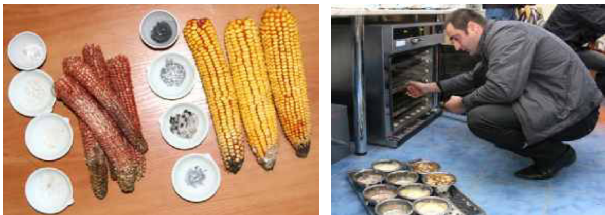
Figura 2. Probe pentru determinarea conținutului de cenușă și aspecte din timpul realizării experimentelor
