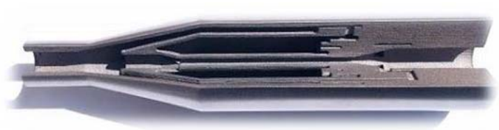
Fig.2. Exemplu piesei (DMLS folosind imprimante de tip MLS;)
