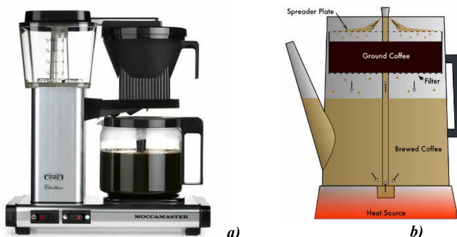
Fig. 1.5. Cafetiere cu percolator: a – filtru de cafea electric de preparare a cafelei; b – filtru de cafea cu proces de percolare multiplă
