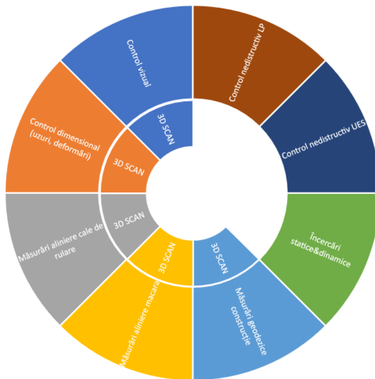
Fig. 1. Volumul examinării componentelor de macara
