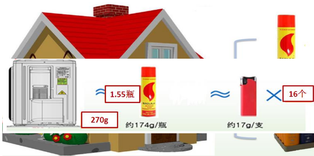
Figura 1. Reprezentare comparativă a diferitor cantități de propan R290, care se conțin în diferite recipiente sau echipamente dintr-o casă de locuit.
