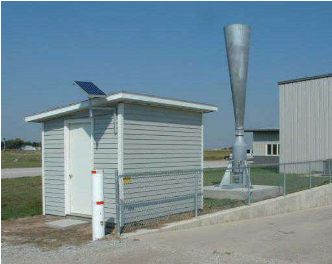
(a) Modelul fix a generatorului de unde șoc anti-grindină.
