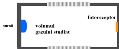
Fig. 2. Schema generală a spectroscopiei prin absorbție
