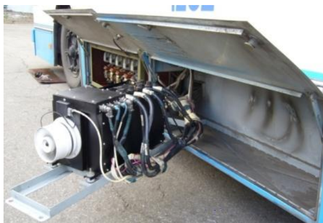
Fig. 2. Modul de amplasare a echipamentului SDMC-103 pe troleibuze de tip 7111
