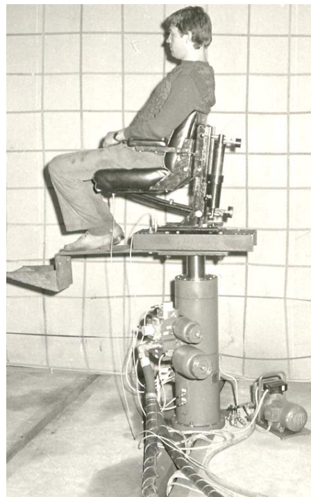
Figura 2. Instalația hidropuls pentru încercări.
