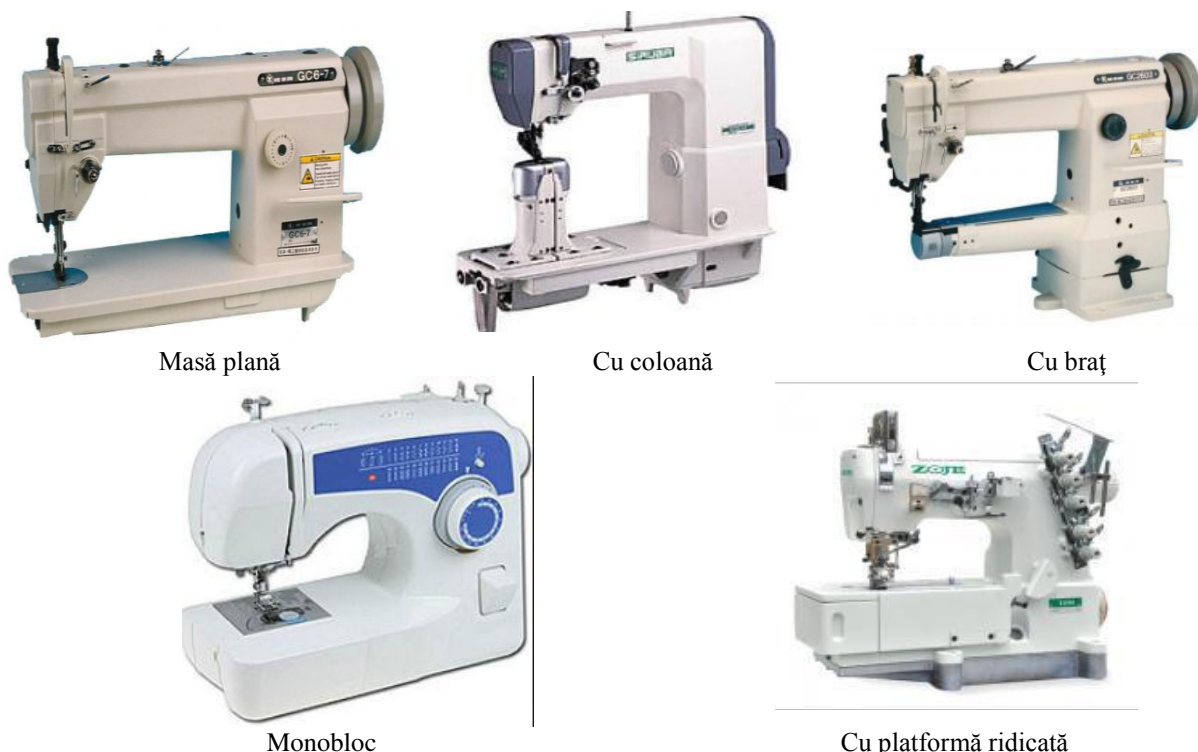
Fig. 3. Mașini de cusut după forma platformei mașinii [6]
