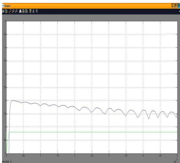
Fig.6. Oscilogrammele convertorului de transformare a tensiunii.
