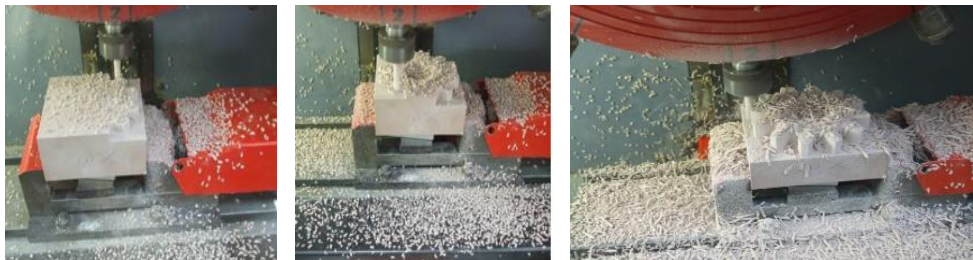
Figura 3: Prelucrări faza de degroșare și finisare
