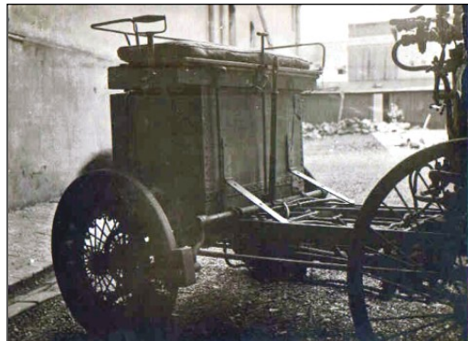
Fig.13. Detaliu spate: se distinge acționarea sabotului de frână printr-un ax la capetele cu tijă, iar la mijlocul lui o pârghie de acționare manuală.
