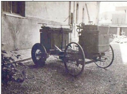
Fig.12. Vedere laterală cu automobilul Văsescu din care se poate constata că roțile directoare din dreapta sunt mai depărtate decât cele motoare din spate.
