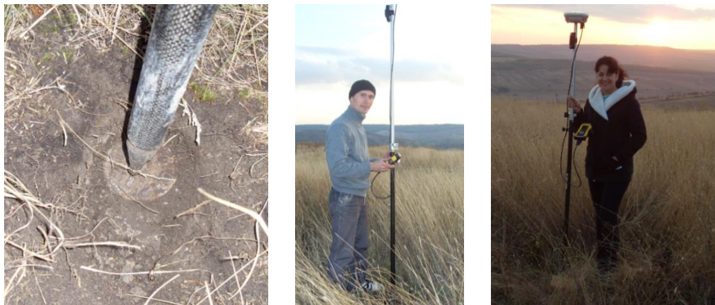
Fig. 3.25 Măsurători GNSS în punctul geodezic D12Romanesti Vest
