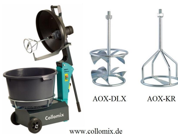
Fig. 1.6. Malaxor în contracurent seria AOX-S cu tobă rotitoare.
