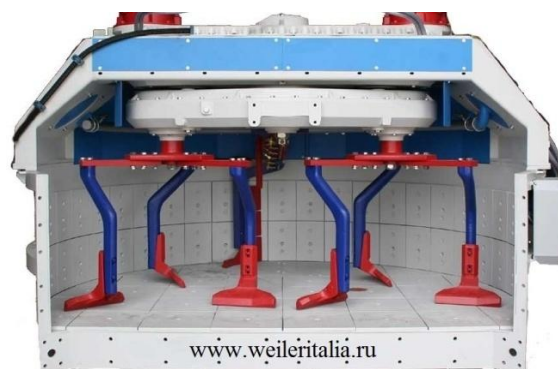
Fig. 1.8. Malaxor planetar cu două stele cu palete.
