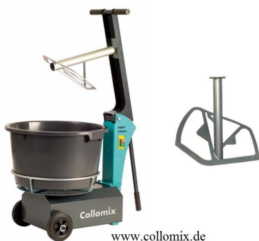
Fig. 1.5. Malaxor în echicurent seria POX-S cu tobă rotitoare și organ de amestecare fix.
