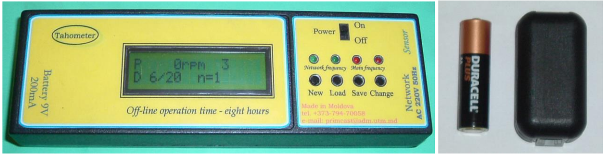
Fig. A.2.9 Imaginea exterioară a dispozitivului de măsurare a turațiilor motoarelor pompelor electrice ermetice și a traductorului de câmp magnetic
