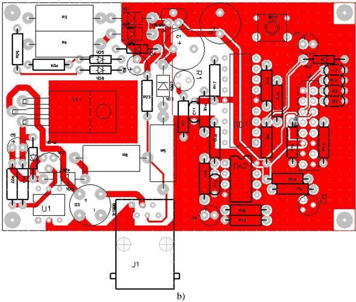
Fig. A.1.24 Cablajul imprimat a plăcii de bază.
