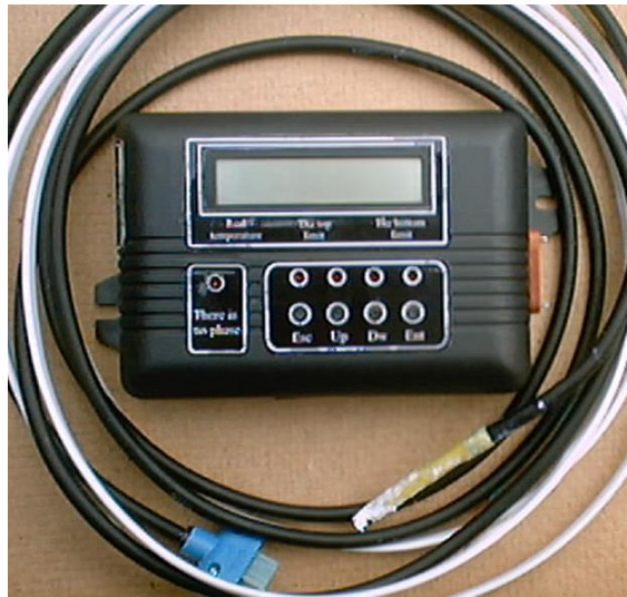
Fig. A.2.10 Imaginea exterioară a blocului de dirijare cu temperatura pentru sisteme autonome de încălzire.
