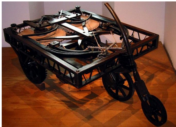
Figura 3: Replica căruciorul autopropulsat al lui Leonardo da Vinci (muzeul Clos Lucé, în apropiere de Château d'Amboise, Franța) [10]
